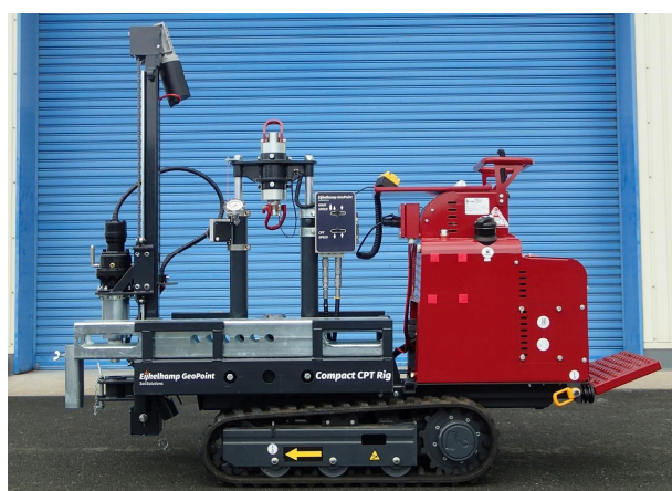
写真-2 自走式貫入装置(Compact CPT-Rig)
