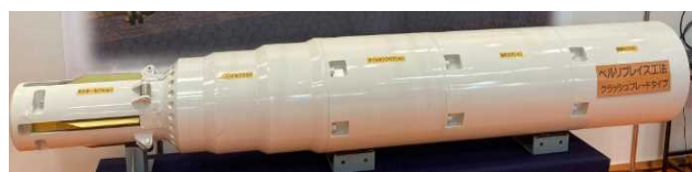
写真-4 改良型破碎機(クラッシュブレードタイプ)
