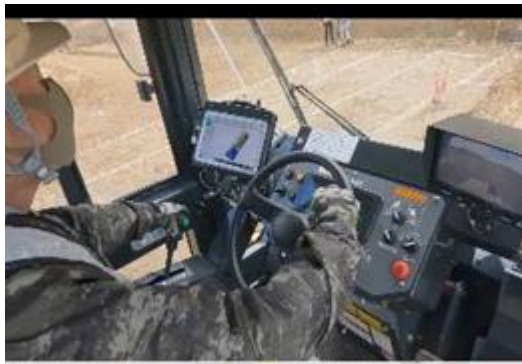
図—2 振動ローラ加速応答の計測状況
