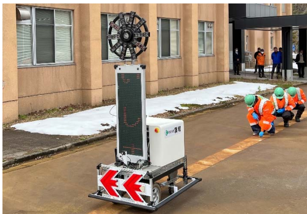
図-3 自律走行台車(先導車)
