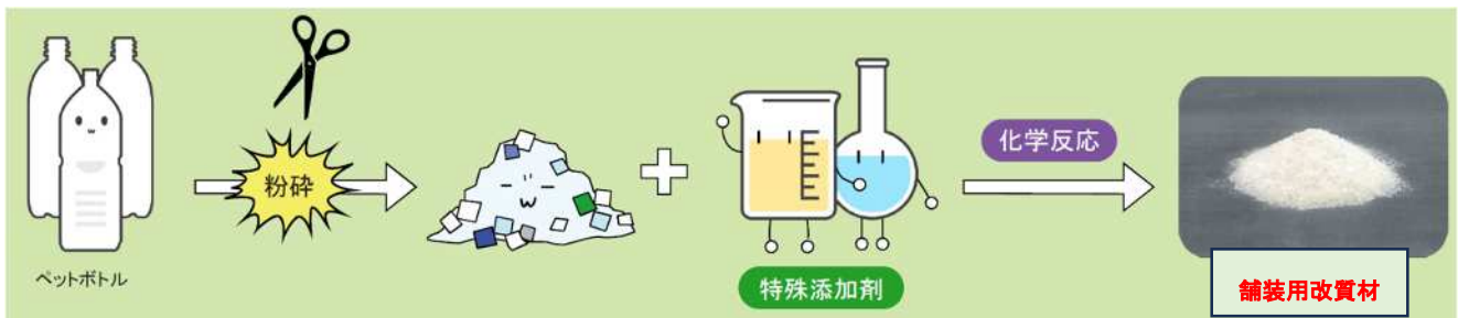
図-1 舗装用改質材の製造過程
