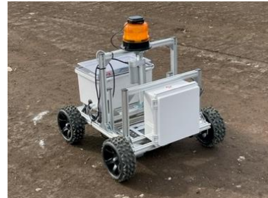
図—3 自走式散乱型 RI ロボット ( \gamma 線型)
