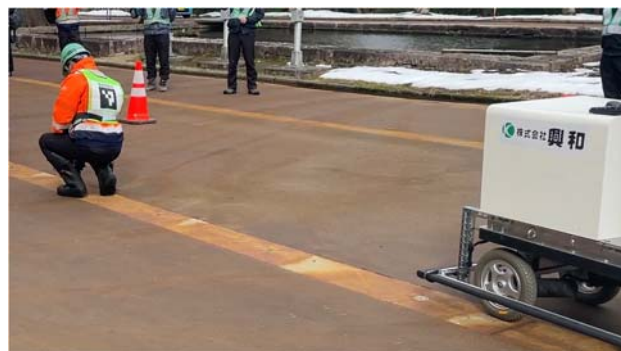
図-4 自律走行台車(後続車)
