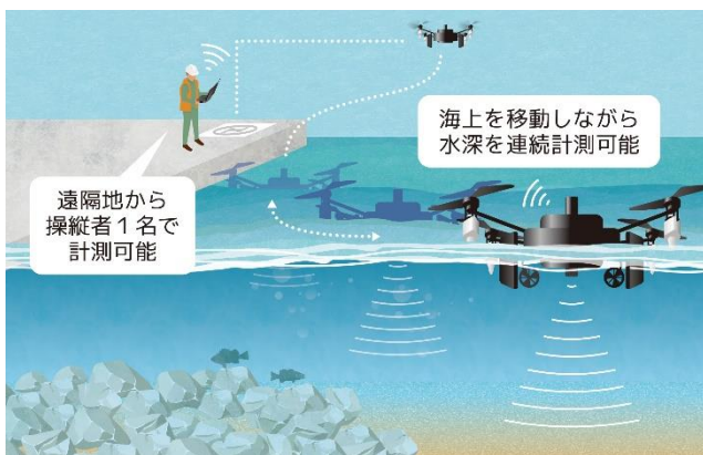
図-1 POV-DAの深浅測量イメージ
