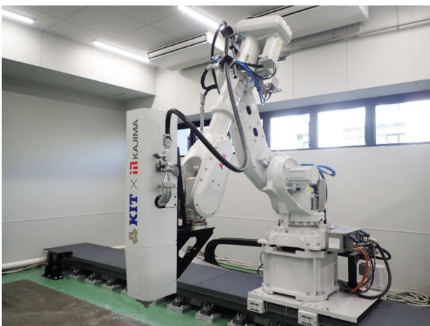
写真-4 ロボットアーム式3Dプリンタ 2)
