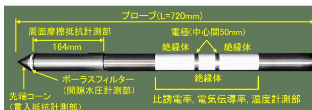
写真-1 WIT-ec-CPT プローブの外観
