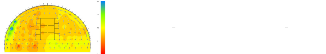
6回目 穿孔エネルギー：77～401J/cm 3 、（平均）131J/cm 3 、穿孔数：139、総装薬数：84.0kg
