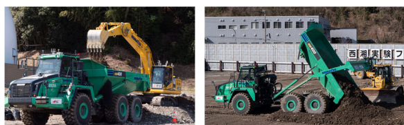
写真ー3 一連作業の自動重機による連携作業
