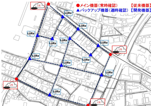
図-1 管路内水位モニタリングの体制
