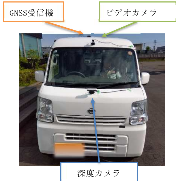
写真-4 計測機器の設置例
