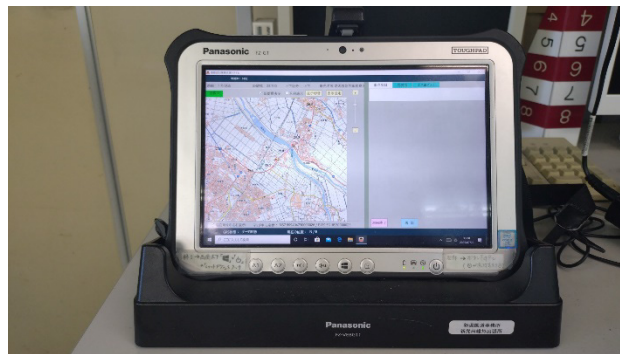
写真-1 道路巡回支援システム
