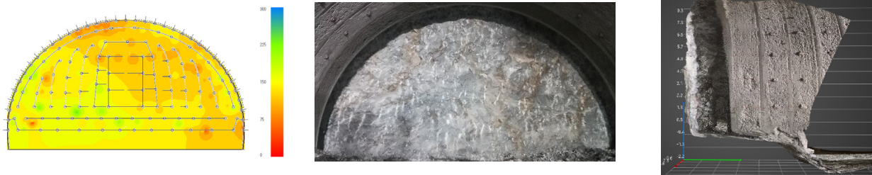
2、3回目 穿孔エネルギー：20～233J/cm 3 、（平均）123J/cm 3 、穿孔数：136、総装薬数：106.0kg
