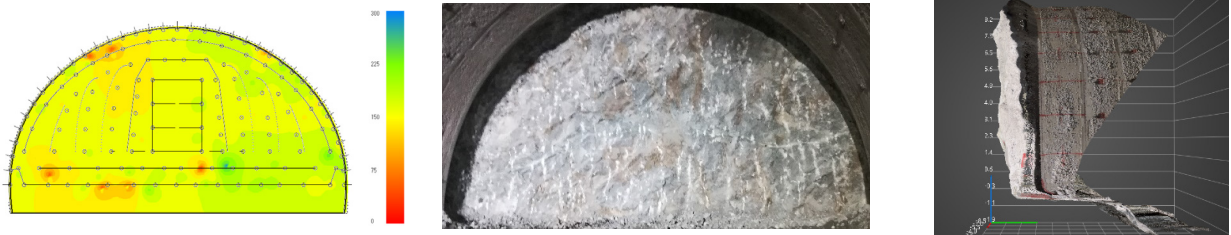
1回目 穿孔エネルギー：91～205 J/cm 3 、（平均）162J/cm 3 、穿孔数：136、総装薬数：123.6kg
