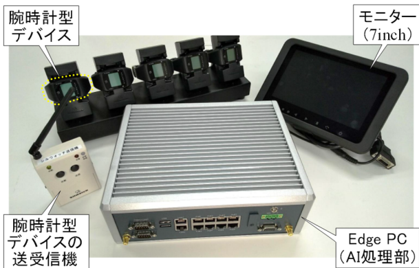
図-2 WIT 3rdEYEのシステム構成
