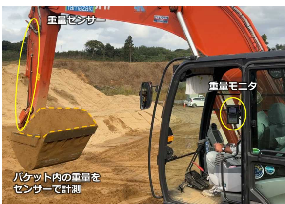
写真-1 荷重判定装置取付イメージ
