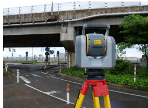
写真 3 レーザースキャナによる測量
