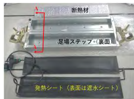
写真-1 発熱シートと足場ステップ
