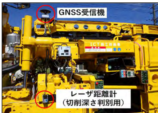
写真－4 システム取付け状況
