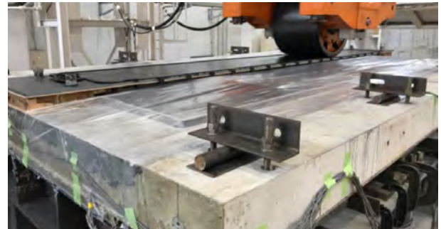
写真-1 輪荷重走行試験（本載荷）の状況
