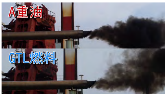
写真-3 スラスト排気ガス比較
