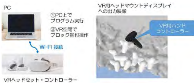
図-6 VRを使用する場合の機器構成
