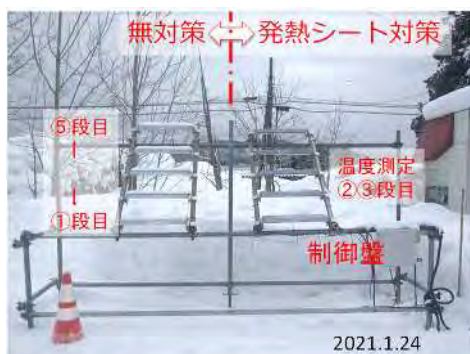
写真 - 2 試験状況 (2022.1.24 6 cm積雪時)
