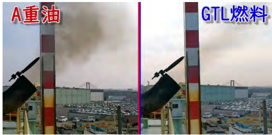
写真-2 クレーン排気ガス比較
