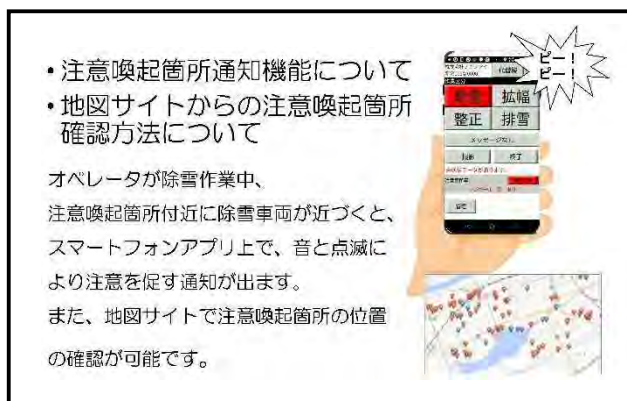
写真－８ 支障物のアラート機能
