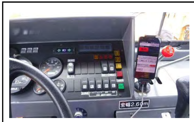
写真－3 除雪車のスマートフォン搭載状況
