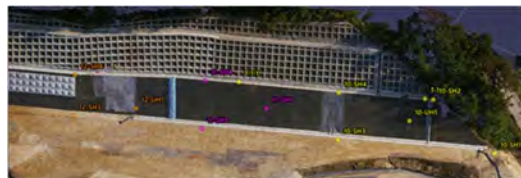
図-6 起工測量データ（＝土工事の完成時データ）
