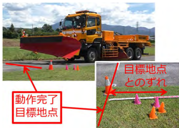
写真-4 自動制御動作精度の確認状況
