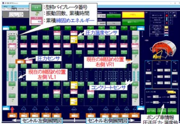
図-3 打込み・締固め状況管理用展開図
