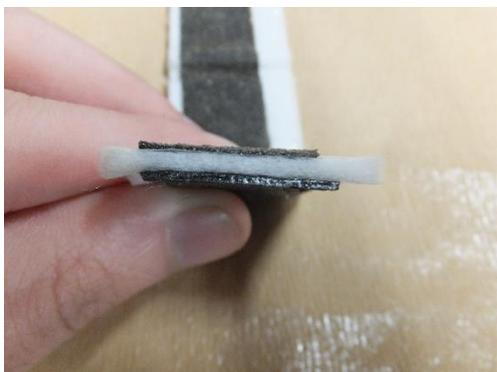
図-1 導水テープの構造断面
