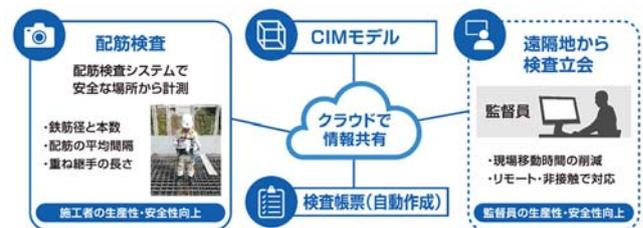
図-5 3眼カメラによる配筋システム概要
