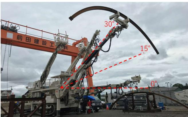
写真-4 たわみ試験の様子(鉛直上向き30°)
