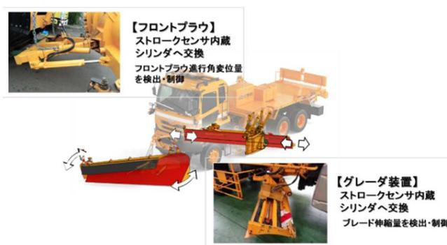
図-5 除雪トラック試験機改良箇所
