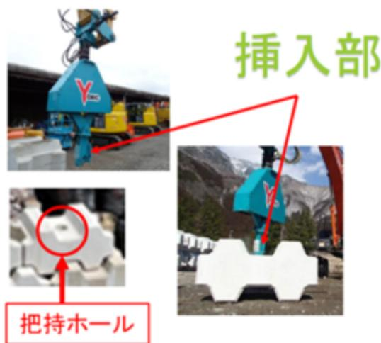
図(写真) - 3 把持装置によるブロックの吊り上げ状況
