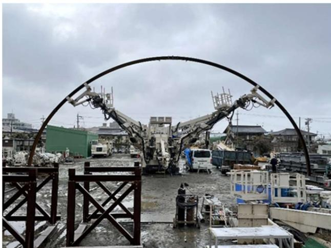
写真-1 完全自動鋼製支保工建込みロボット
