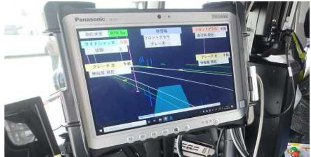
写真-2 自動操作制御装置
