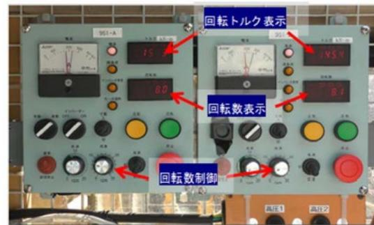
写真-3 インバータモータ制御盤
