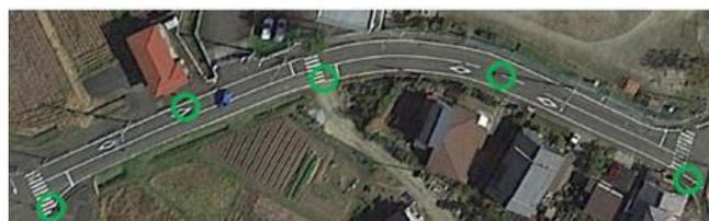
写真-2 TS による標定点設置状況
