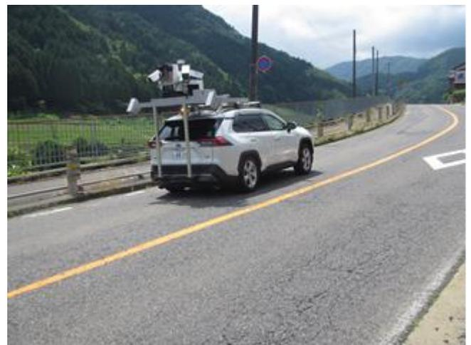
写真-1 MMS による計測状況
