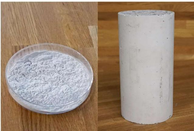
写真1 カーボンリサイクルによる炭酸カルシウム(左)とカーボンリサイクル・コンクリート(右)
