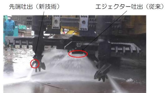
写真-4 先端吐出機構
