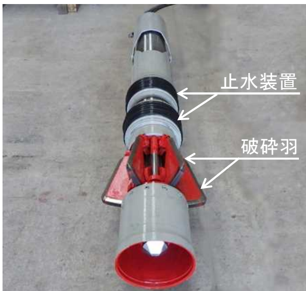
写真-1 パイロット破碎機
