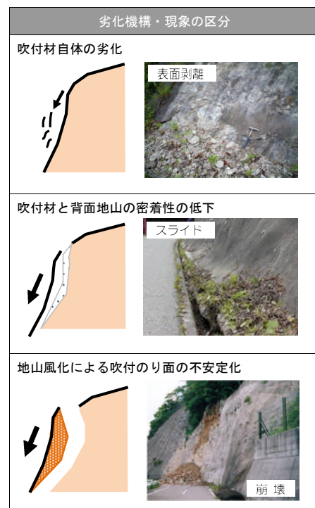
図-1 吹付のり面の劣化機構・現象区
