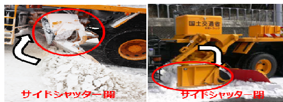
写真-3 サイドシャッターの動作状況
