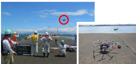
写真-1 UAV（ドローン）による航空測量
