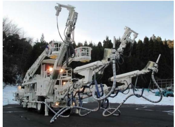
写真-6 エレクタ付2ノズル吹付け機
