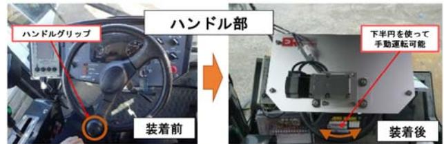
図-6 ハンドル部のロボット機構
