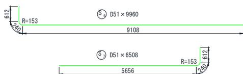
図-5 鉄筋加工図
