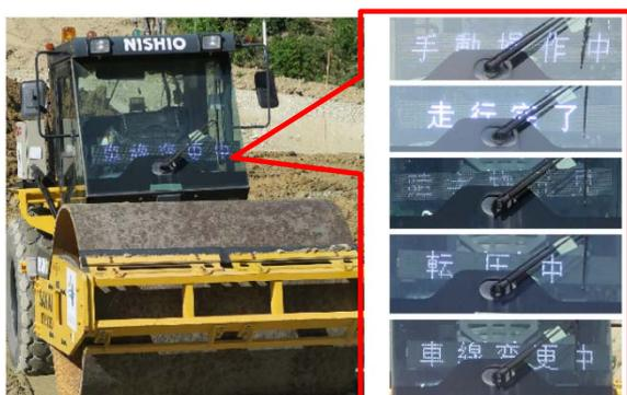
図-10 電光掲示板による「見える化」
