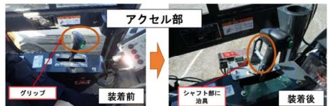
図-7 アクセル部のロボット機構
