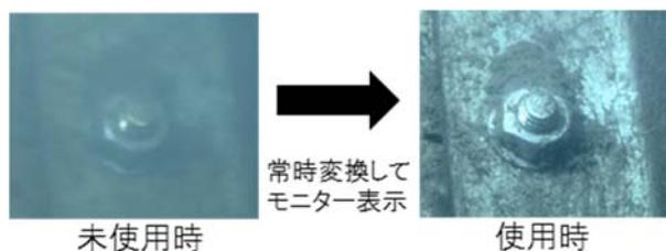
図-3 画像詳細強化装置による効果
