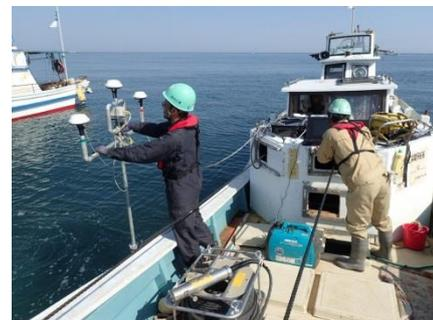
写真-2 水中基準点測量
