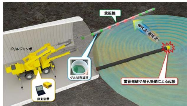
図-1 探査概念図（鳥瞰図）
