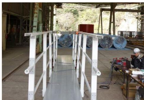
写真-4 手摺の静的載荷試験(水平)
