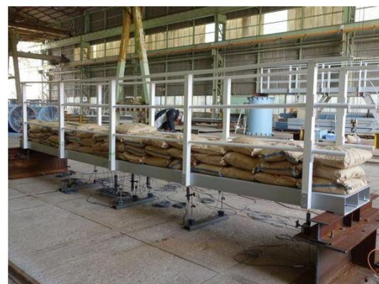
写真-2 歩廊静的載荷試験(鉛直)
