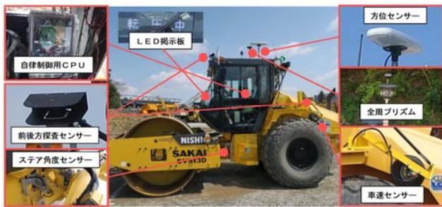
図-4 センサー搭載状況
