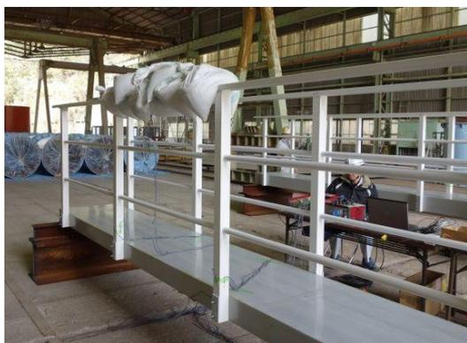
写真-3 上段手摺 静的載荷試験(鉛直)
