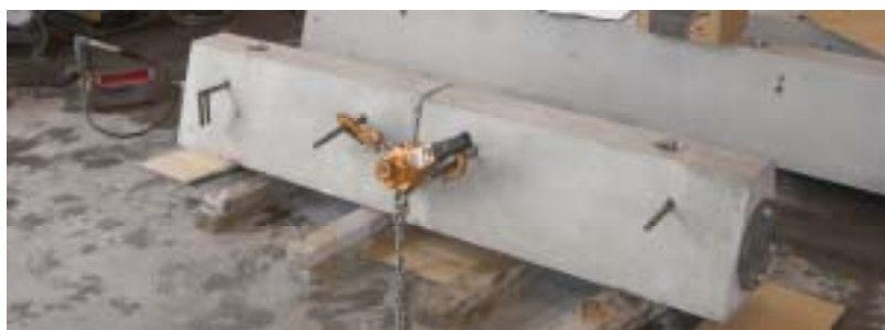
写真－6 止水性能確認試験状況
