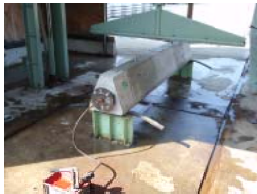
写真－5 曲げ試験状況
