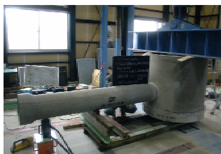
写真－4 誘導目地に沿って破断した供試体
