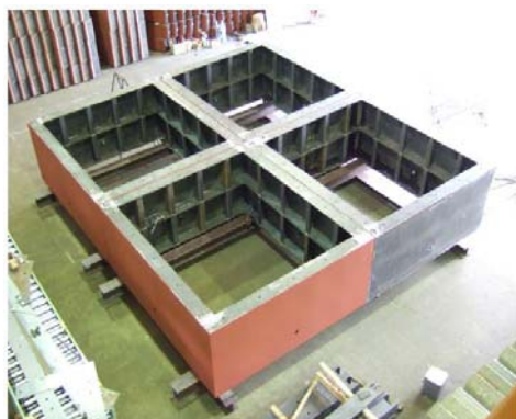
写真－1 鋼殻仮組状況
