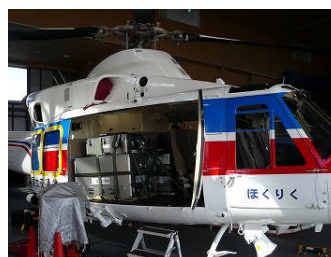
写真-13 ユニットの 固縛状況
