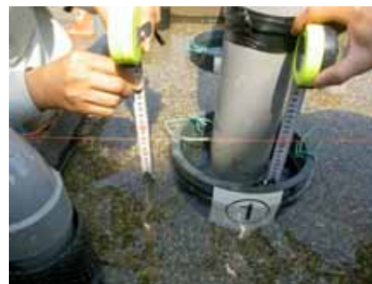
図－3 内外水位差測定状況
