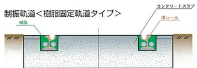
図-1 樹脂固定軌道の概念図
