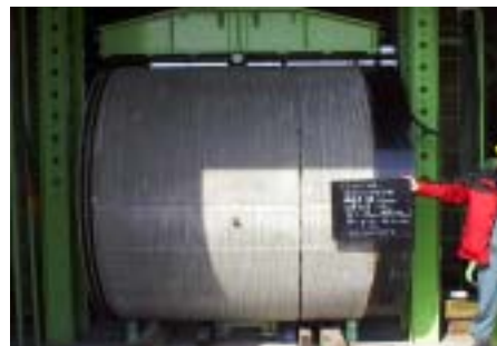
写真－３ 誘導目地に沿って破断した供試体
