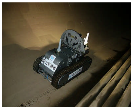
写真-12 管内調査
