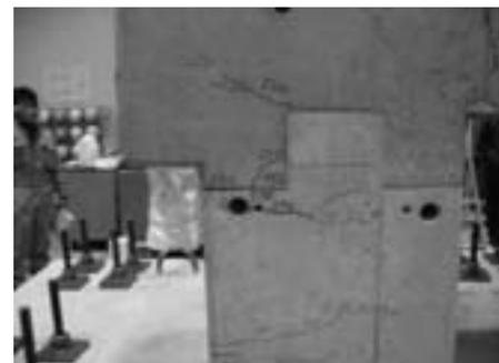
写真-4 隅角部(上下部連結部)の固定状態確認
