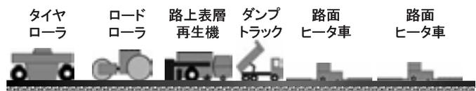
図-2 試験施工における機械編成
