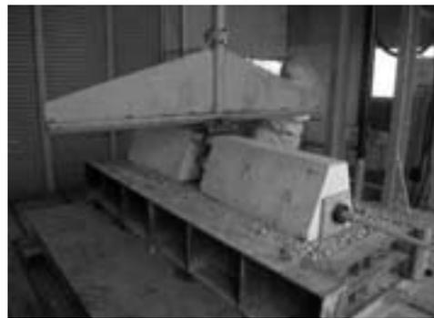
図 6 曲げ破壊試験状況
