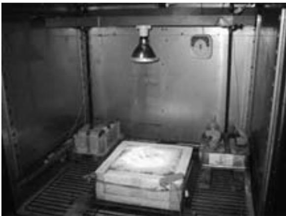
写真-7 カキ氷による融雪確認試験
