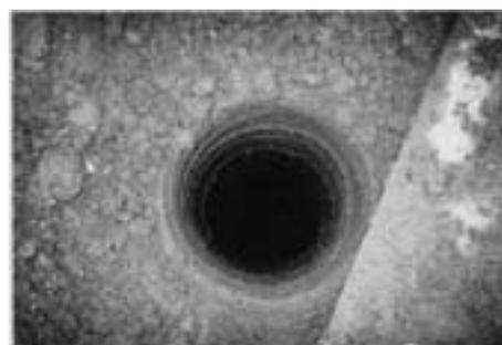
写真-1 孔壁の自立状況
