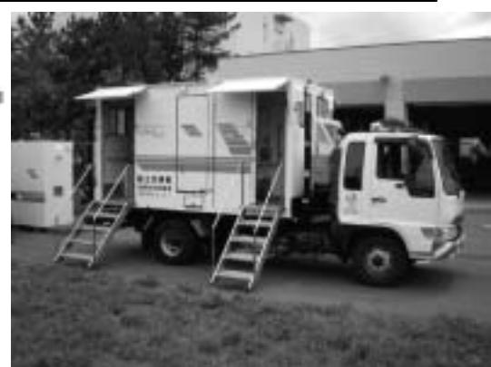
写真-2 災害用トイレ(車載時)
