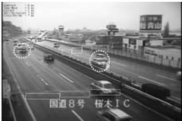
図-6 車両の誤認識例
