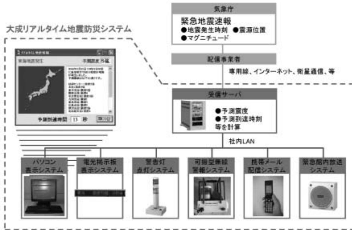
図－1 大成リアルタイム地震防災システムの構成
