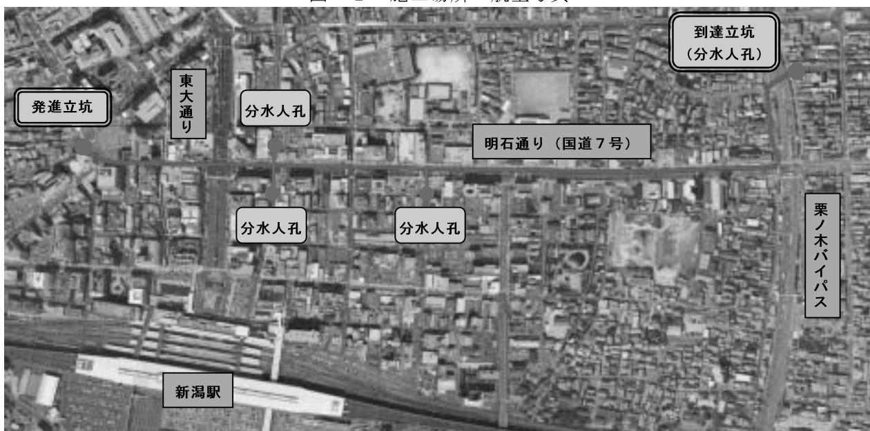
施工場所は全域が密集した市街地であり（図－1 施工場所の航空写真参照）、発進立坑は古くからの木造家屋やホテル・オフィスビルが混在して建ち並んでいる中の狭隘な公園用地に設けています。（防音ハウス面積約 810 m<sup>2</sup>）また、到達立坑や分水人孔の築造箇所は市道内であり、作業にあたって全面通行止めや車線減少などの交通規制を行なっています。
