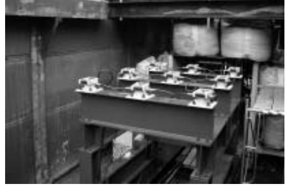
図-10 高さ調整ローラー試験状況
