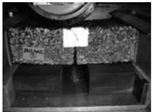
写真-1 クラック抑制舗装評価試験
