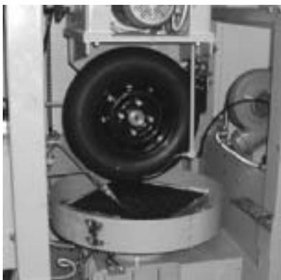
写真-1 骨材飛散抵抗性試験機
